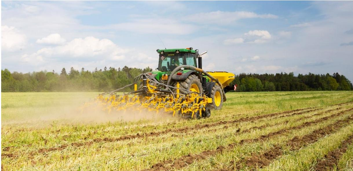
La bineuse de rangs STRIP – MASTER EN peut être utilisée pour ameublir le sol en bandes et ce, jusqu'à une profondeur de 25 centimètres. Nous vous recommandons d'atteler cette machine à des trémies à engrais **FERTI-BOX FB\_F** ou à **des véhicules-trémies FERTI-CART FC, COMBO SYSTEM CS** afin de pouvoir appliquer de l'engrais sur deux couches distinctes. Il sera également possible d'appliquer des engrais liquides ou du lisier et du digestat.
