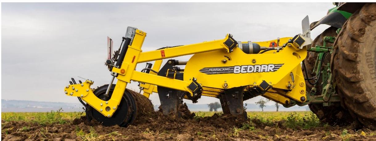
Les machines TERRALAND TN pourront dès à présent aussi être équipées **de roues d'appui qui amélioreront le maintien de la profondeur de travail réglée dans la partie avant de la machine et d'une paroi latérale à basculement hydraulique** qui améliorera le confort de l'opérateur. Dans la variante de la machine équipée de socs ZERO – MIX, nous vous recommanderions d'installer sur la machine un **lourd rouleau en acier CUTPACK** qui réalisera la consolidation finale de la surface du sol.
