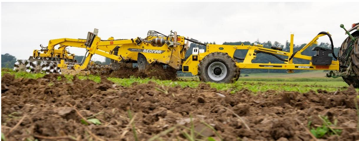
Pour que le transport sur les routes soit sûr, le porte-outils CADDY CD a été équipé de pneus de transport à large profil. Associé au contrepoids situé à l'avant, cet équipement améliore la répartition de la masse de la machine et garantit ainsi une meilleure stabilité durant le transport.
