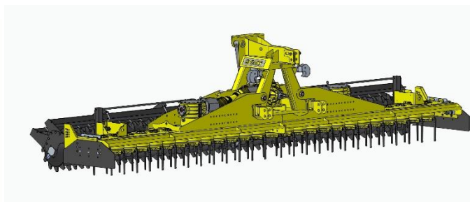
Brony wirnikowe BEDNAR KATOR b  d   dost  pne w wersji sztywnej 3 m po lewej, oraz sk  ladanej hydraulicznie 6 m, po prawej.
