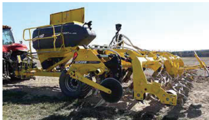
Obr. 1. Hluboký řádkový kypřič TERRASTRIP ZN8R nesený na taženém velkoobjemovém zásobníku hnojiv FERTI-CART FC 3500 pro vyvíjenou technologii řádkového kypření, na pěstební rozteč řádků 75 cm s regulací pracovní hloubky v rozpětí 25 – 45 cm.
