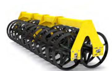
Le double V-RING est un rouleau composé d'anneaux en forme de V. Cela garantit une faible adhérence des pièces au rouleau. Les arceaux du rouleau sont insérés l'un dans l'autre, de sorte qu'il n'y a pas d'obstruction.
