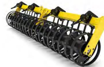
Rouleau en acier à une rangée à cerceau. Rouleau adapté aux types de sols légers. Une bande de nivellement est associée au rouleau qui permet de niveler la surface devant le rouleau.
